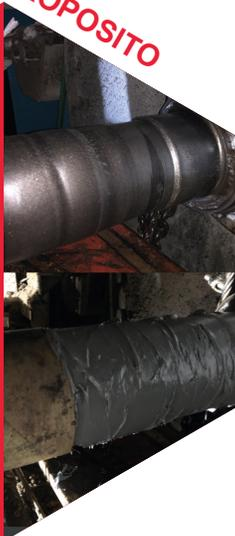
Puede ser perforado, tapado, trabajado en un torno, lijado y pulido. Puede ser usado para reparar ejes gastados, empaquetaduras y bloques de motor quebrados, roscas desgastadas, ranuras irregulares, ranas hidráulicos rasgado, manga del eje/piolas de buje demasiadas grandes, etc. Emparejable, no requiere calor.
