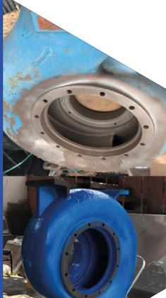
Es ideal para cubrir, rellenar y proteger los equipos propensos al ataque de cavitación, así como la creación y reparación de juntas flexibles, asientos, etc.
