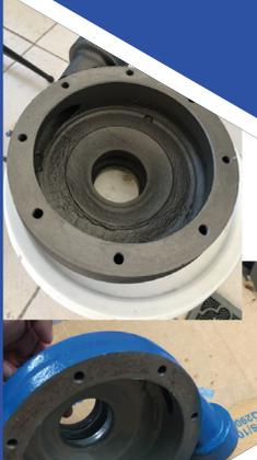
basado en dos componentes, 100% sólidos, con consistencia líquida compuesta de polímero elasto-cerámica formulada específicamente para superficies y proteger los equipos sujetos a la cavitación acelerada erosión / corrosión.
