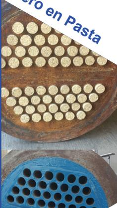
combina la fuerza superior, durabilidad y adhesión de un epóxico con la flexibilidad excepcional, abrasión, resistencia y absorción de choque de un uretano elastomérico.
